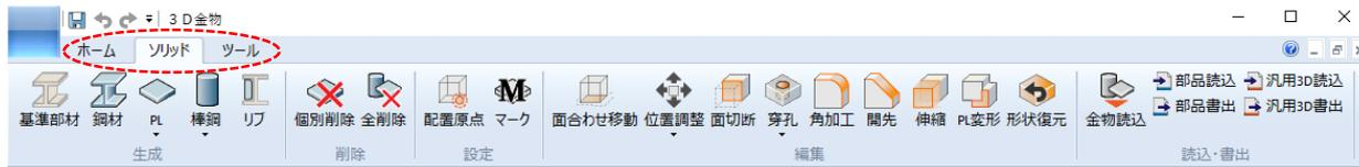
ソリッドタブには、鋼材、PLなどソリッドを生成するコマンドや、面合わせ移動、穿孔などソリッドを移動/加工するコマンドが用意されています。
